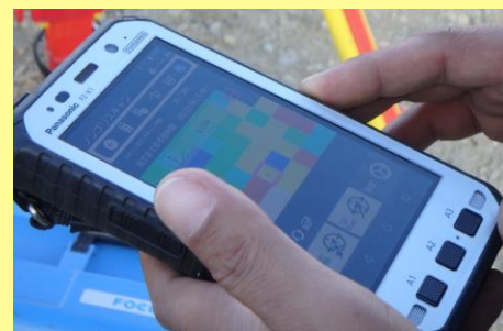
建設システム SITE-Scopelにて 設計データと観測した実在点による 面的出来形評価
